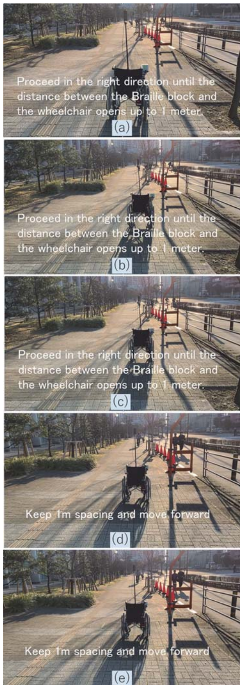
図6 車椅子が自動走行中に、点字ブロックとの横距離が1mになるよう自動調整している様子
