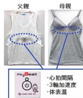
図1 肌着タイプのウェアラブル心拍センサ
