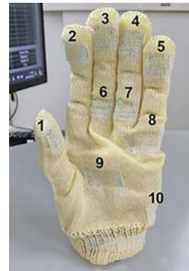
図5 2層構造の編み部分を10箇所導入して編み上げた無給電状態で静的および動的な圧力センシングが可能な手袋
