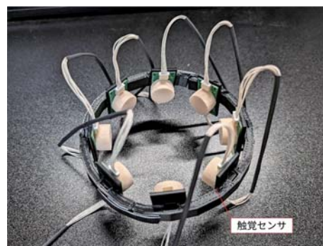
図1 柔軟な触覚センサを備えたリング型デバイス
