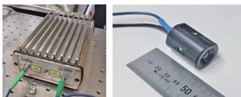
図3 テラヘルツ波の発生に用いる連続テラヘルツ波フォトミキシング光源。(左) 励起用の半導体レーザーと(右) フォトミキサー本体。
