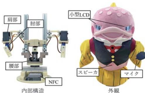
図2 アシストロボット「小ドンマス」の構造
