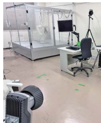
図4 VRのインターフェースを用いて、ロボットの操作をするために用いたモーションキャプチャシステムと、操作対象となった多関節ロボット
