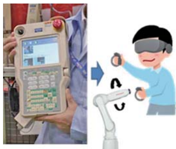
図2 左：従来産業用ロボットの操作に用いられてきたティーチングペンダント。右：今回用いる産業用ロボットと、それをバーチャルリアリティを介して遠隔操作する操作者の概念図。
